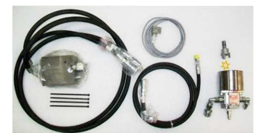
Motorisation hydraulique du malaxeur de BRIQUETICC
