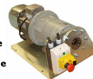
PLANETICC V2 : Construction et maintenance du réducteur épicycloïdal de DECHIQUETICC
