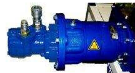
Motorisation hydraulique du malaxeur de BRIQUETICC
