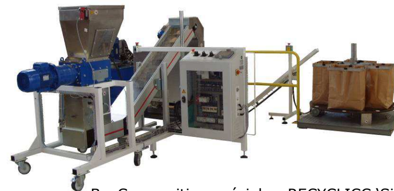
B - Composition spéciale : RECYCLICC 'Simplex' dispose des mêmes parties opératives mais d'une gestion centralisée avec un seul pupitre de contrôle et de commande.
