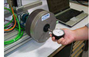
Mesures physiques : relevé de vitesse par tachymètre mécanique
